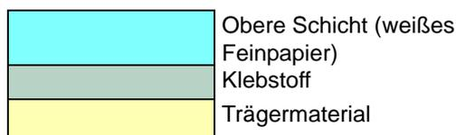
Etiketten bestehen aus drei Schichten (siehe Abbildung). Der Druck erfolgt auf der oberen Schicht. Die Kleberschicht enthält druckempfindliche Klebstoffe. Das Trägermaterial hält die Etiketten bis zur Verwendung zusammen. Auf Grund seiner Zusammensetzung ist Etikettenmaterial besonders anfällig für Druckprobleme.
